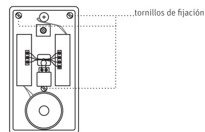
5. Coloca la placa de acero en la base plástica, asegúrate que la parte superior de la placa se inserte como se indica en la figura. Empuja la placa al ras de la base plástica y atornilla.
