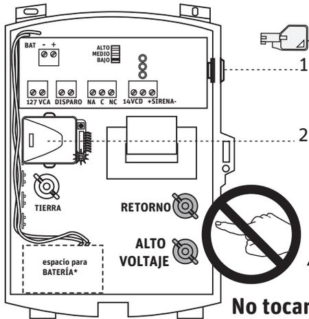
1. Chapa para encendido y apagado de la central con la llave.
