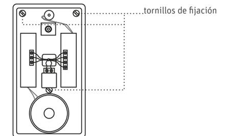
5. Coloca la placa de acero en la base plástica, asegúrate que la parte superior de la placa se inserte como se indica en la figura. Empuja la placa al ras de la base plástica y atornilla.
