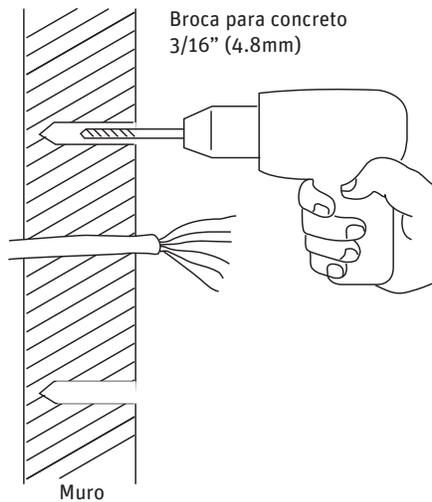
2. Fija la base plástica a la pared con los tornillos y los taquetes que viene con el equipo.
