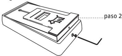
2. Quita la placa de aluminio introduciendo la llave allen por la entrada del tornillo de seguridad y colócala abajo de la placa de acero. Empuja hacia abajo para hacer palanca y sacar el frontal.
